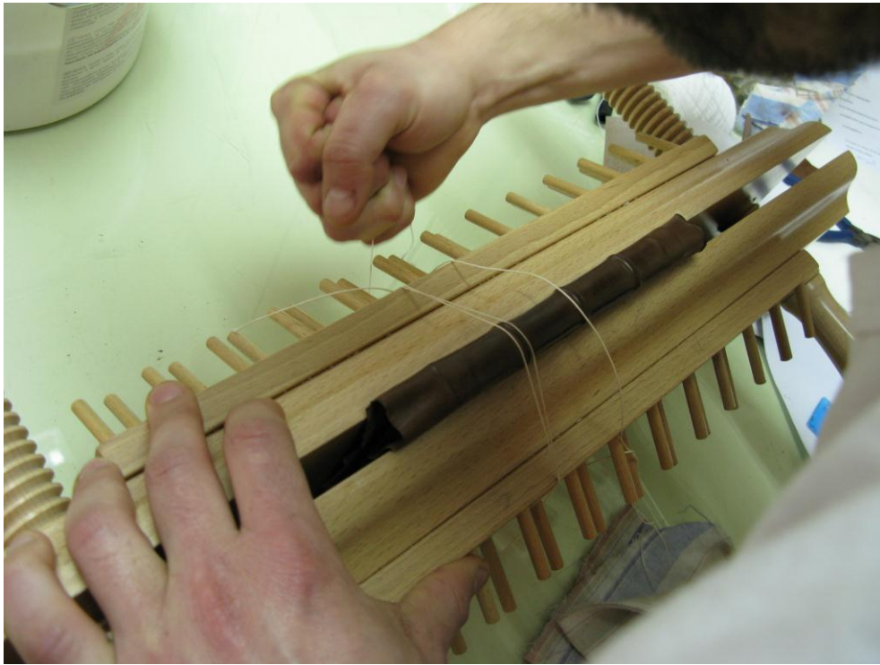
Slika 63. Napinjanje špage oko vezica
