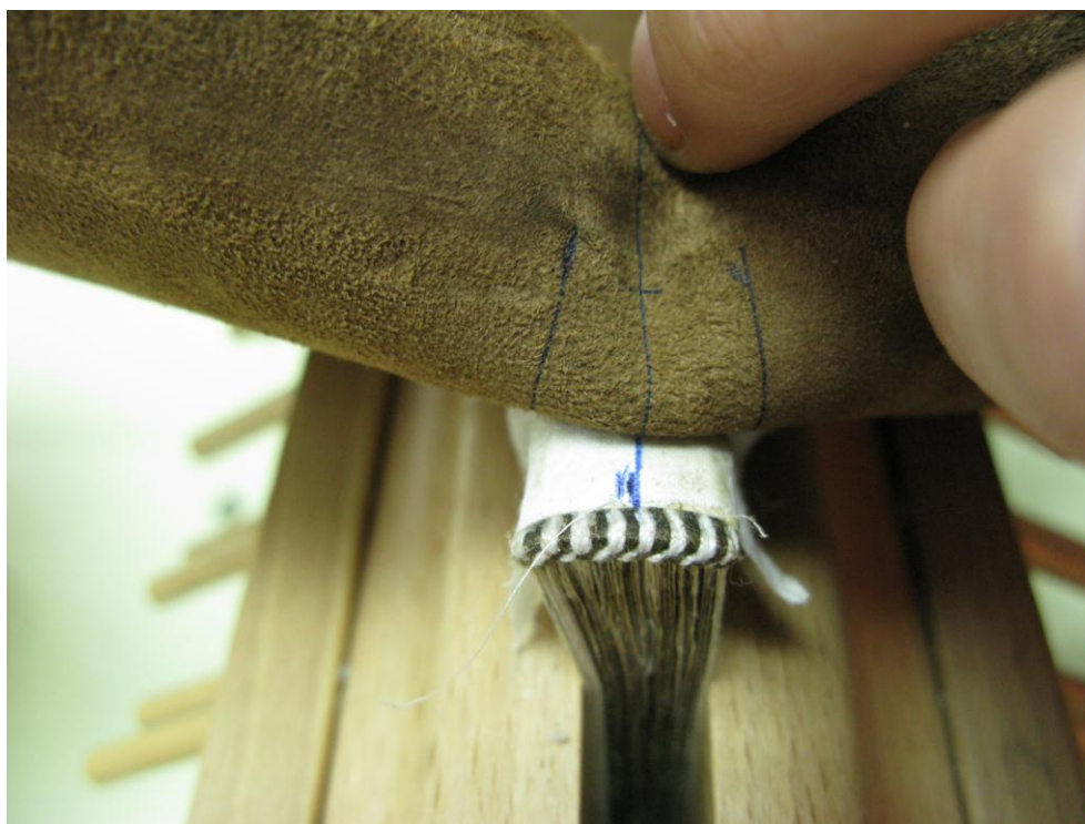
Slika 61. Spajanje kože sa hrptom knjižnog bloka
