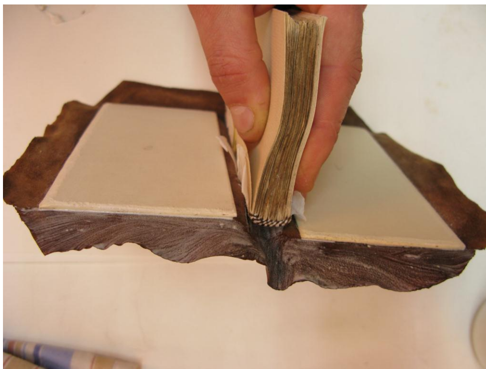
Slika 67. Izrada čmrlje iznad zaglavne vrpce
