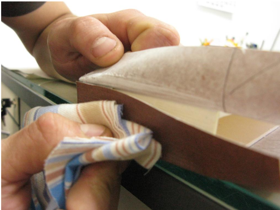
Slika 88. Naribavanje platna pamučnom krpicom
