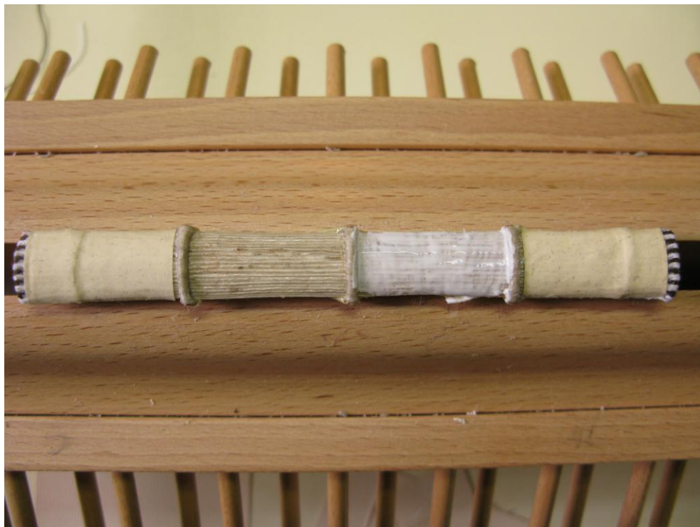
Slika 53. Ljepljenje kašmira na hrbat
