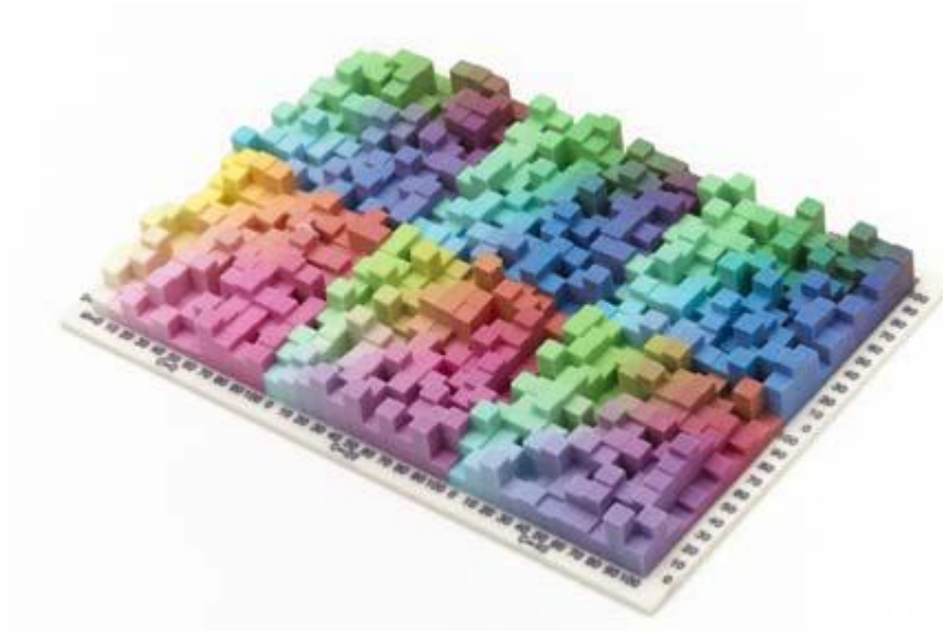
Slika 1. Primjer objekta isprintanog 3D ink jet tiskom (ZCorporation, 2005)
