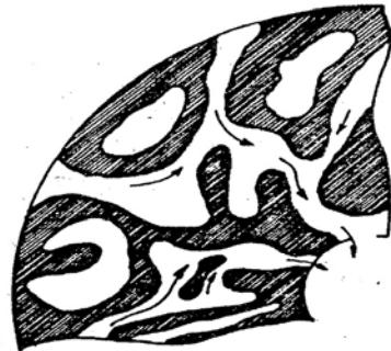
Izgled dijela površine papira prilikom mjerjenja na Bekkovom aparatu. Neravnine dovode do toga da se usisavanje zraka odigrava kanalima samo preko dijela površine.
