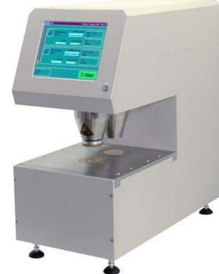
Uzorak se stavlja na **staklenu pločicu** iznad koje se nalazi mjerna glava, s ispitivanom stranom prema dolje. Pritiskom na tipku **START** na uzorak se spušta mjerna glava pritišćući uzorak na staklenu pločicu masom od 10 kg. Potom se, pomoću vakuumskih pumpi, isprazni spremnik za zrak do ciljanog tlaka od 50.7 kPa. Ovisno o hrapavosti ispitivanog uzorka, preostali zrak između površine papira i staklene pločice – **usisava se u spremnik** – sve dok tlak ne padne na 48.0 kPa.
